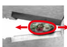
力が分散し、ケーブルが逃げるので切断しにくい。その結果、ケーブルが潰れてしまう。
